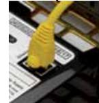
Une sortie Ethernet (Modbus TCP)
