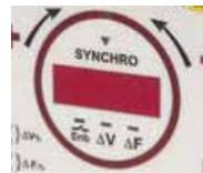
Affichage de 3 mesures en digital : phase, fréquence et tension
