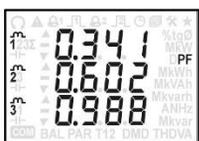
Ici les FP des phases 1 et 2 sont anormalement faibles, cela pouvant être dû à une inversion entre les capteurs de ces deux phases.
