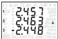
Ici le courant de la phase 3 est négatif, le capteur de courant flexible sur cette phase est potentiellement installé à l'envers ou mal raccordé.
